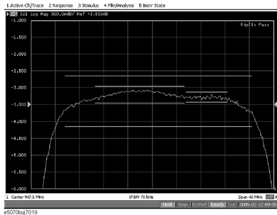
図 8-14 リップル・リミットの設定例（図 8-13 のリミット・テーブルの場合）
